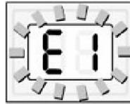
In caso di sonda guasta, il display indica "E1". L'apparecchio emette un avviso acustico escludibile con la pressione del tasto SET.
